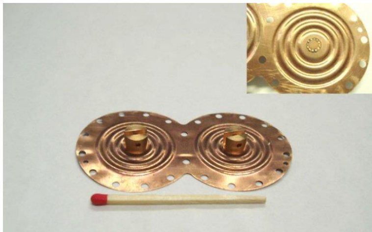
Sl.2 Mehatronička komponenta izrađena laserskim mikrozavarivanjem
